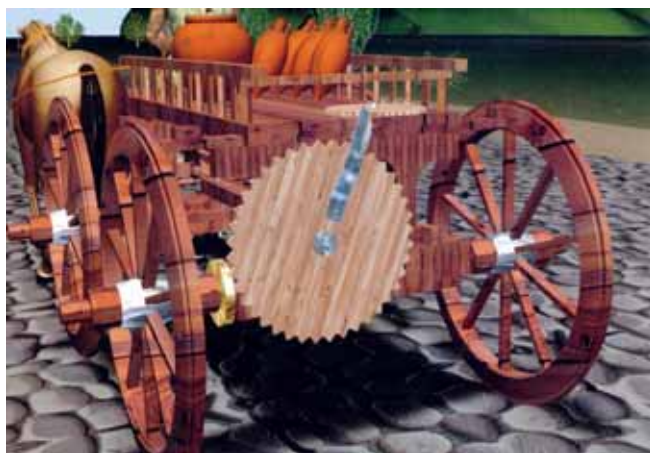
A sinistra: Ricostruzione della macchina descritta nel 1 sec d.C. da Vitruvio per la misurazione delle distanze: la ruota in legno, collegata all'asse del carro, fa cadere una pallina in un raccoglitori al completamento di ogni suo giro. A destra: modello funzionante della gru calcatoria, impiegata per sollevare pesi e blocchi da costruzione in età ellenistica romana
