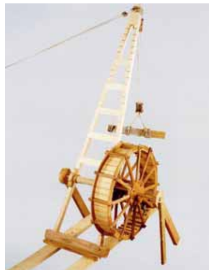
A sinistra: Ricostruzione della macchina descritta nel 1 sec d.C. da Vitruvio per la misurazione delle distanze: la ruota in legno, collegata all'asse del carro, fa cadere una pallina in un raccoglitori al completamento di ogni suo giro. A destra: modello funzionante della gru calcatoria, impiegata per sollevare pesi e blocchi da costruzione in età ellenistica romana
